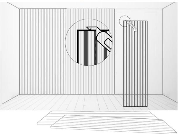
• Il est possible de modifier la largeur de vos panneaux en découpant la feutrine à l'aide d'un cutter ou d'une lame tranchante pour obtenir une découpe nette et régulière. Une fois la découpe effectuée, vous n'avez plus qu'à visser la partie découpée et admirez le résultat!
